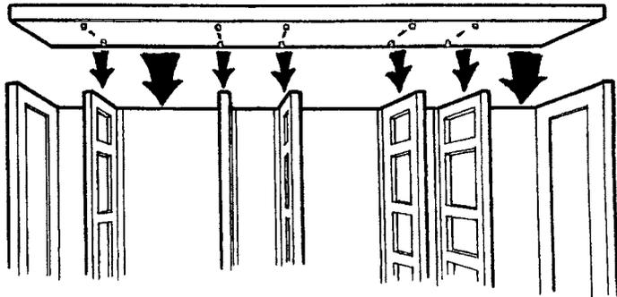
Auf der Oberseite rechts und links schlagen Sie je 2 von den langen Verbindungsstiften ohne Kopf ein. Ebenfalls von oben stecken Sie die Laschen zur Verbindung mit den Innenwänden ein und fixieren diese Verbindungen von unten mit je 1 Spannkeil und 1 kurzen Befestigungsstift.
