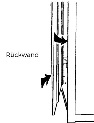
**4.** Linke Rückwand von hinten wie abgebildet zunächst angehoben schräg in die seitliche Nut der mittleren Rückwand einstecken, dann gerade drehen, so dass sie in die hintere Führungsnut des Unterbodens einrasten kann. Wie bei der linken Rückwand von hinten wieder 2 Verbindungsstifte zur Seitenwand einschlagen.
