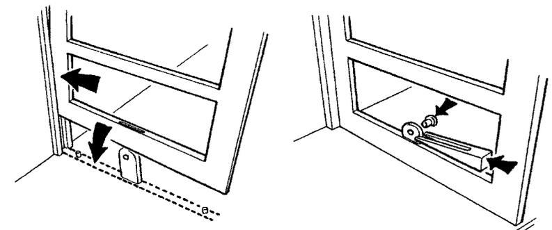
**5.** Die Innenrahmen setzen Sie mit der kantigen Seite (Hinterrseite ist mit Abschrägungen versehen) nach vorn ein. Am Unterboden werden die Innenrahmen mit je 1 Spannkeil und 1 kurzen Befestigungsstift fixiert.
