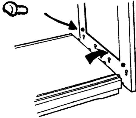
**2.** Zum Verbinden mit den Seitenwänden heben Sie den Unterboden etwas an und stecken ihn mit der jeweiligen Seitenwand zusammen. Durch Klopfen auf den Unterboden werden die Teile fest zusammengefügt. Sichern Sie den Boden mit 4 Sicherungsstiften links und rechts.
