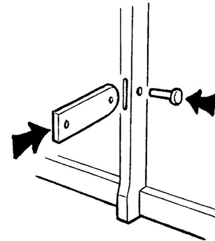
**1.** Stellen Sie den Unterboden senkrecht mit der Rückseite am Boden auf. Laschen mit der Rundung voraus von der Unterseite her in die Schlitz stecken und mit je 1 langen Befestigungsstift sichern. Für den weiteren Zusammenbau legen Sie den Unterboden flach mit etwa 70 cm Abstand zur Wand auf, damit Sie von hinten noch Teile montieren können. Die doppelte Führungsnut gehört nach vorn.
