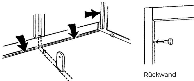
**3.** Beginnen Sie mit der rechten Rückwand, welche 2 Leisten auf der Innenseite aufgeleimt hat. Heben Sie die Rückwand in die hintere Führungsnut am Unterboden und rücken Sie sie an die in der Zeichnung angegebene Stelle. Von hinten 2 abgeflachte Verbindungsstifte zur Seitenwand einschlagen.
